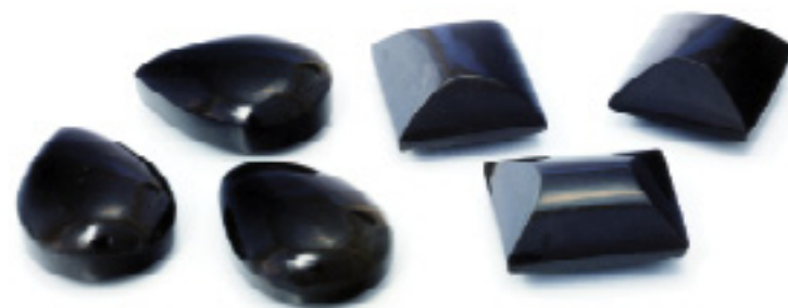
Figura 22: Cabochões em ônix de Enori da Silva, produzidos em fresadoras copiadoras pantográficas com formas padronizadas e em série. Fotografia: Antonio Liccardo.
