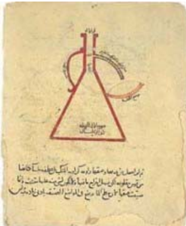
El aparato de Al Biruni para medir densidades de gemas en un manuscrito de Al Jazani, físico de Jorasán (Persia) del s. XI. www.muslimheritage.com
