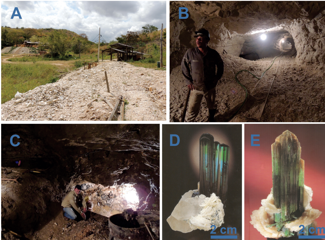
Figura 20. Frente Mutuca da lavra Santa Rosa (Franciscópolis). A) Aspecto da pilha de rejeitos, observando-se ao fundo, direita e esquerda, as duas entradas para alcançar o corpo em profundidade (foto dos autores). B) Detalhe da galeria de acesso ao corpo mineralizado (foto dos autores). C) Detalhe da frente serviço ao encontrar um caldeirão mineralizado em turmalinas (foto dos autores). D-E) Imagens de peças magníficas de coleção encontradas nesta área (fonte: Cornejo & Bartorelli 2010 ).
