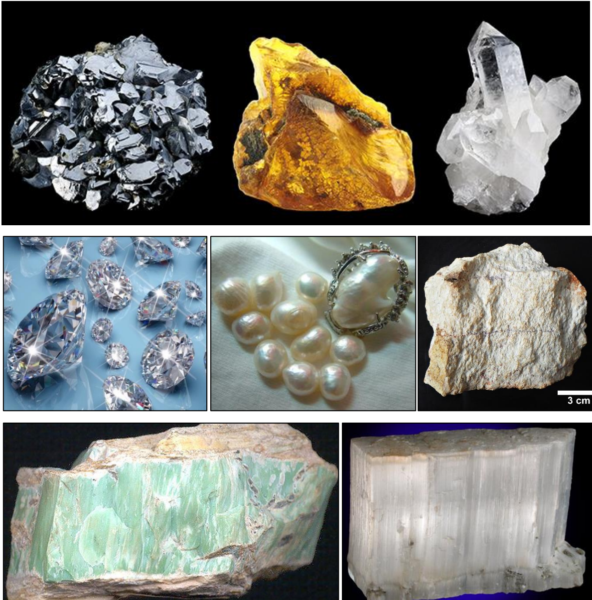
Figura 16: Tipos de brilho em minerais. Da esquerda para direita e de cima para baixo: brilho metálico em hematita, brilho resinoso em âmbar, brilho vítreo no quartzo, brilho adamantino em diamante, brilho perláceo em pérola, brilho terroso em bauxita, brilho resino em variscita e brilho sedoso em gipso. Fonte: Vision Learning (2005); Getty Imagens (2020).
